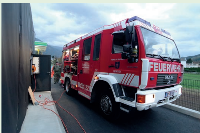
Notstromversorgung durch Einsatzkräfte bei BP-Tankstelle
